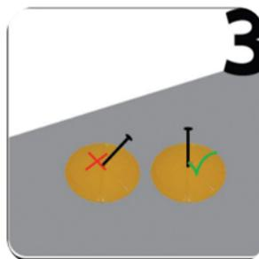
Sujetar sujetar con clavo 3" X 1/4
